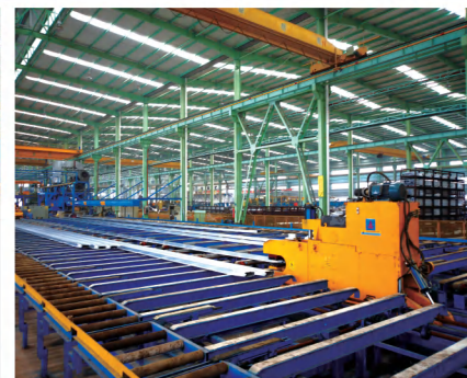
9000吨及5000吨挤压生产线 9000 ton and 5000 ton Extruding press
